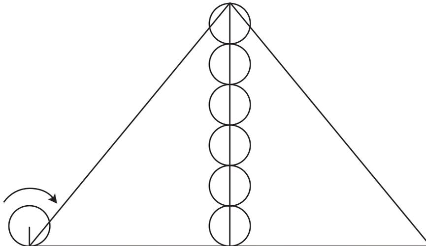
Abbildung 7: Umfang und Durchmesser einer Rolle als Pyramidenmaß.  $n$  Umdrehungen der Rolle für die Pyramidenseite und  $2n$  Durchmesser für die Höhe ergeben eine Pyramide mit der Proportion  $2s : h = \pi$ .
